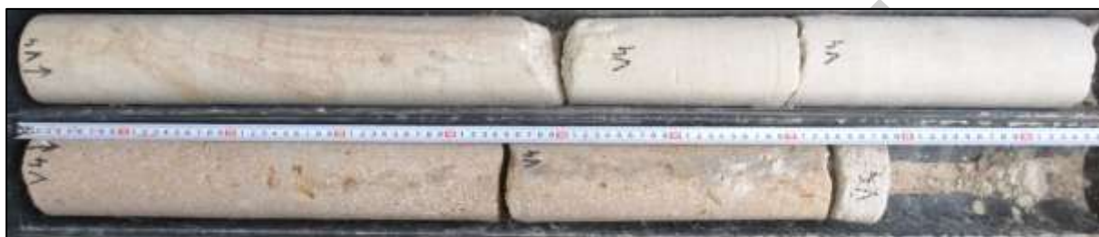
Foto 22: Celkový pohled na vývrt V4 – celková délka vrtu cca 1,75 m
