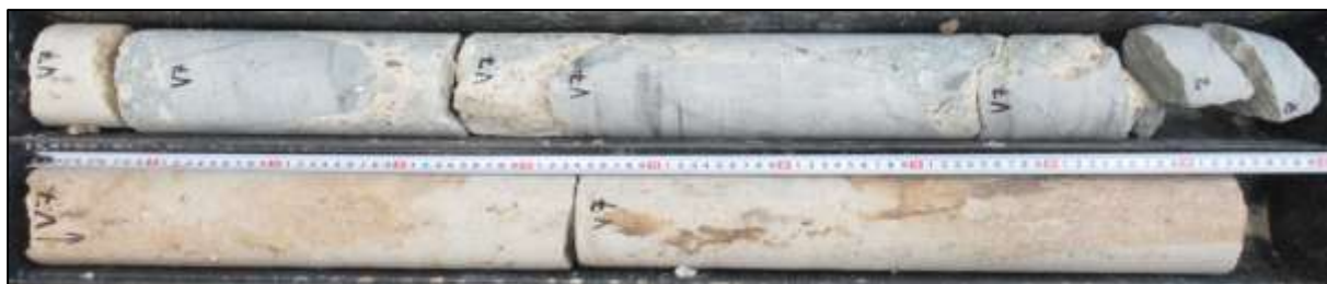
Foto 46: Celkový pohled na vývrt V7 – celková délka vrtu cca 1,95 m
