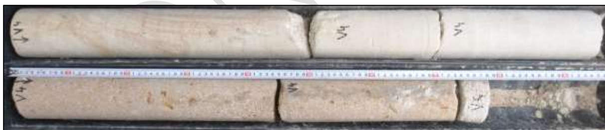
Foto 7: Celkový pohled na vývrt V4 – celková délka vrtu cca 1,75 m, navrtáno do 2 m.
