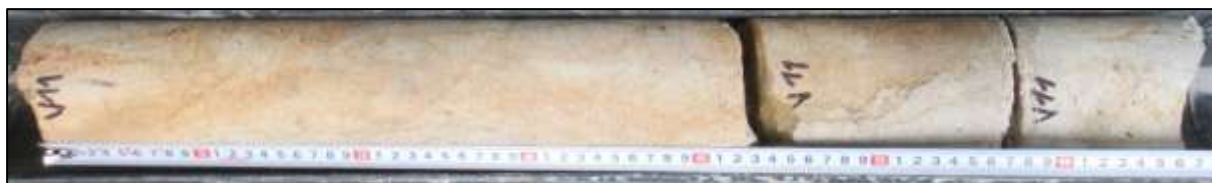
Foto 78: Celkový pohled na vývrt V11 – celková délka vrtu cca 0,67 m
