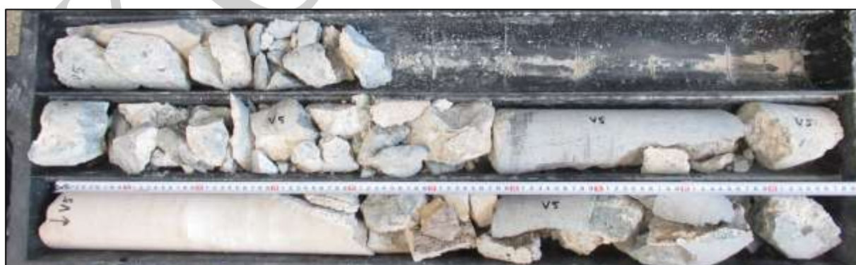
Foto 29: Celkový pohled na vývrt V5 – celková délka vrtu cca 2,4 m
