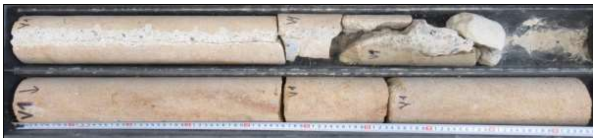
Foto 1: Celkový pohled na vývrt V1 – celková délka vrtu cca 1,8 m
