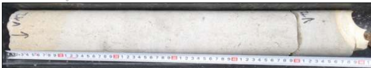
Foto 82: Celkový pohled na vývrt V12 – celková délka vrtu cca 0,6 m
