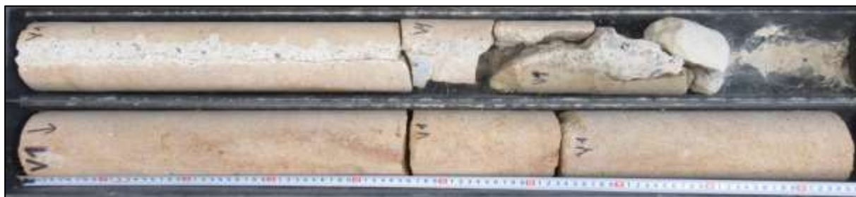
Foto 4: Celkový pohled na vývrt V1 – celková délka vrtu cca 1,8 m, navrtáno do 2 m.
