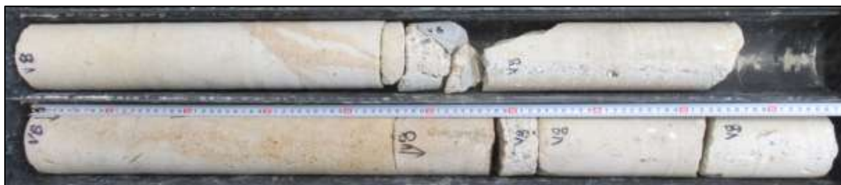
Foto 54: Celkový pohled na vývrt V8 – celková délka vrtu cca 1,82 m
