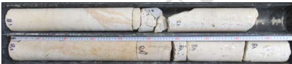
Foto 11: Celkový pohled na vývrt V8 – celková délka vrtu cca 1,82 m, navrtáno do 2 m.
