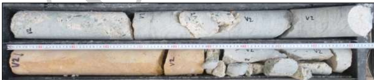
Foto 8: Celkový pohled na vývrt V2 – celková délka vrtu cca 2,05 m
