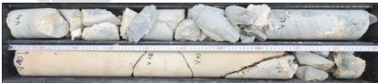
Foto 13: Celkový pohled na vývrt V10 – celková délka vrtu cca 1,95 m, navrtáno do 2 m.
