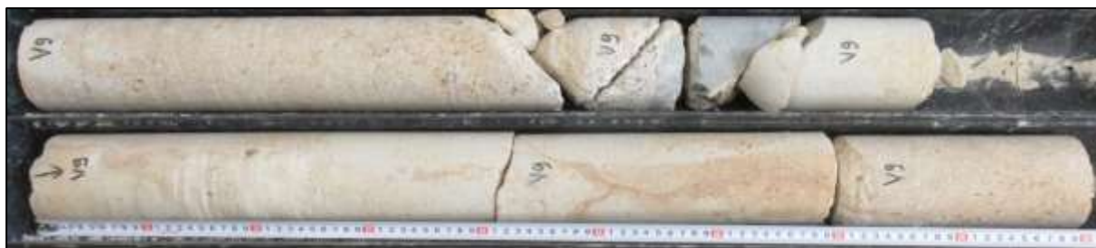
Foto 62: Celkový pohled na vývrt V9 – celková délka vrtu cca 1,7 m
