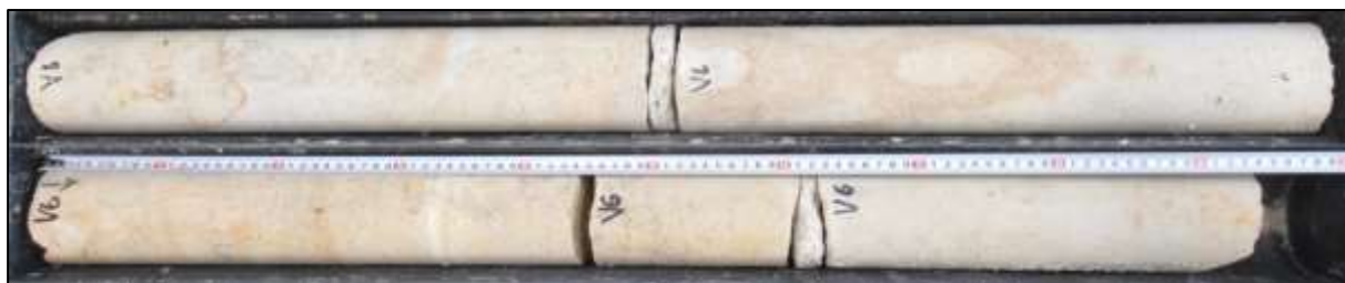
Foto 9: Celkový pohled na vývrt V6 – celková délka vrtu cca 1,97 m, navrtáno do 2 m.
