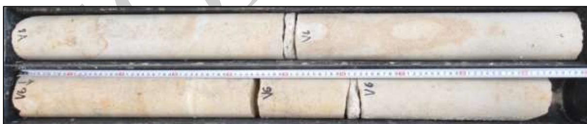
Foto 37: Celkový pohled na vývrt V6 – celková délka vrtu cca 1,97 m
