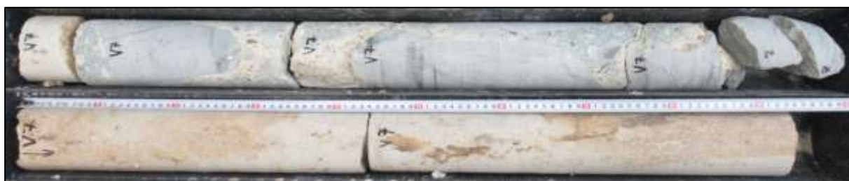
Foto 10: Celkový pohled na vývrt V7 – celková délka vrtu cca 1,95 m, navrtáno do 2 m.
