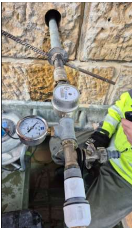
Foto 20: Provádění VTZ na jádrovém vrtu.
