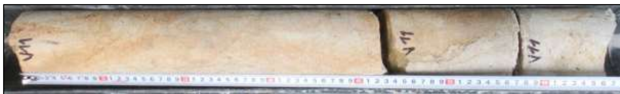
Foto 14: Celkový pohled na vývrt V11 – celková délka vrtu cca 0,67 m
