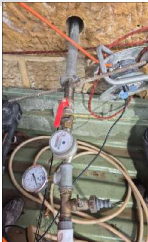
Foto 21: Provádění VTZ na jádrovém vrtu.
