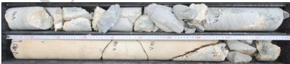
Foto 69: Celkový pohled na vývrt V10 – celková délka vrtu cca 1,95 m
