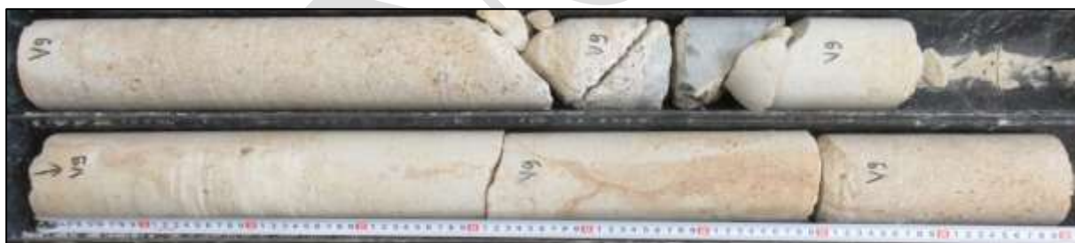
Foto 12: Celkový pohled na vývrt V9 – celková délka vrtu cca 1,7 m, navrtáno do 2 m.
