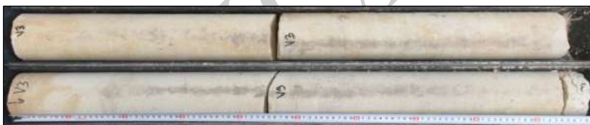
Foto 15: Celkový pohled na vývrt V3 – celková délka vrtu cca 1,95 m
