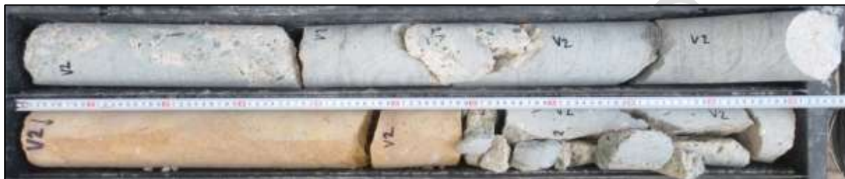
Foto 5: Celkový pohled na vývrt V2 – celková délka vrtu cca 2,05 m, navrtáno do 2 m.
