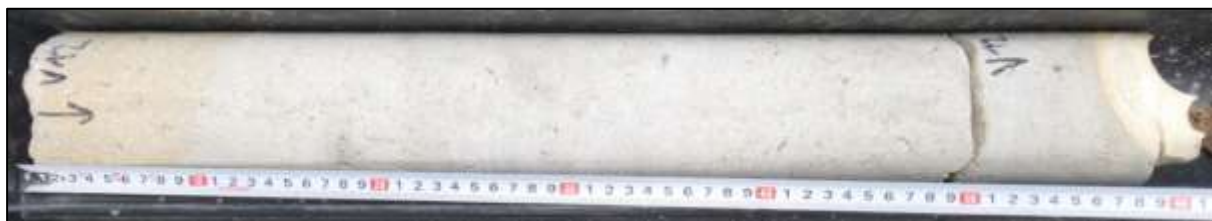
Foto 15: Celkový pohled na vývrt V12 – celková délka vrtu cca 0,6 m
